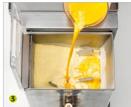
3 Das verquirlte Ei oder das Wasser in den Mischbehälter geben. Den Deckel schließen und auf „Mischen“ schalten.
